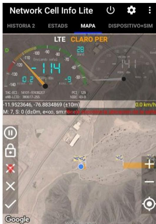
Figura 13 Cobertura 4G LTE CLARO en la Quebrada de Jicamarca
