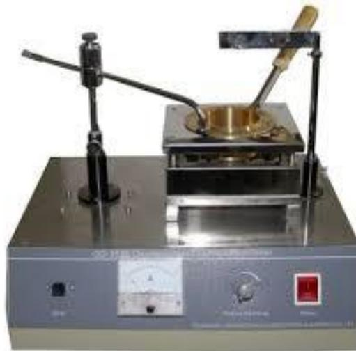
*Figura 8. ASTM D92 Instrumento Para Punto de encendido C.O.C*
