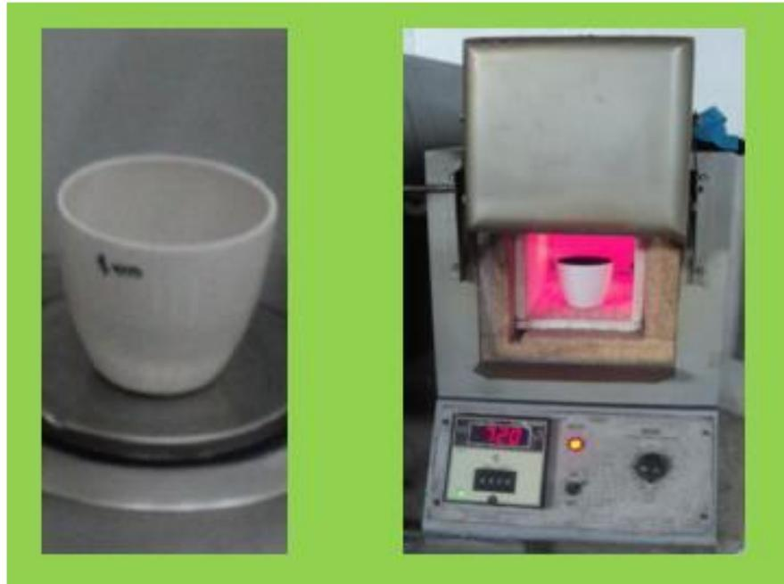
Figura 25. Equipo para determinar el contenido de cenizas, Método ASTM D874.
