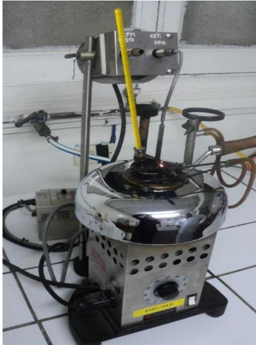
*Figura 27.* Instrumento para determinar punto de encendido C.O.C, Método ASTM D92
