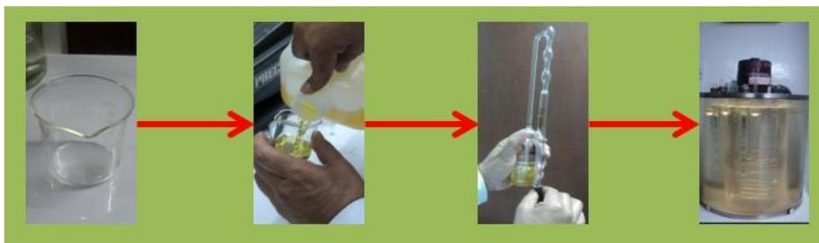
Figura 30. Procedimiento para la viscosidad cinemática, Método ASTM D445.
