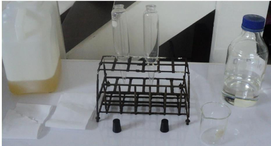
Figura 23 Instrumentos para determinar el contenido de agua y sedimentos,
