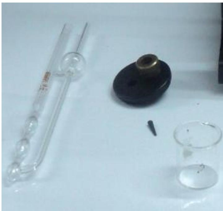
Figura 30. Equipo para determinar la viscosidad cinemática, Método ASTM D445.
