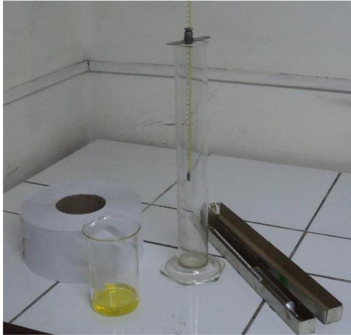
*Figura 21.* Equipos para determinación de la Densidad ASTM D1298
