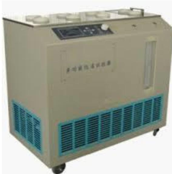
*Figura 9.* ASTM D97 Instrumento que determina el punto de Congelamiento
