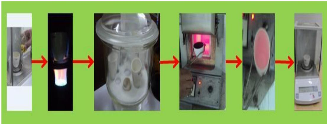
Figura 26. Procedimiento para determinar de cenizas, Método ASTM D874.
