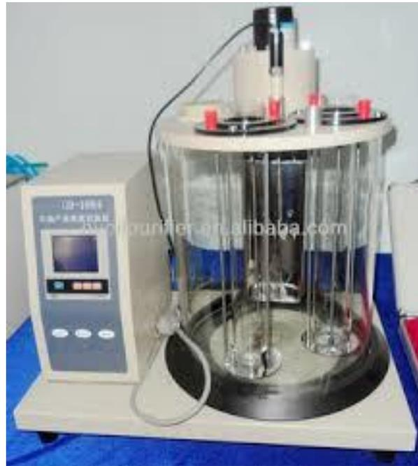
*Figura 7. ASTM D1298 Instrumento para La Densidad o gravedad Api*
