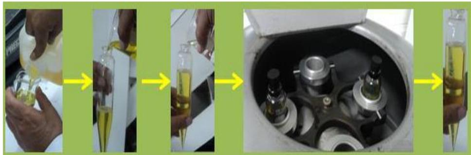
*Figura 24.* Procedimiento para determinar el contenido de agua y sedimentos, Método ASTM D 1796
