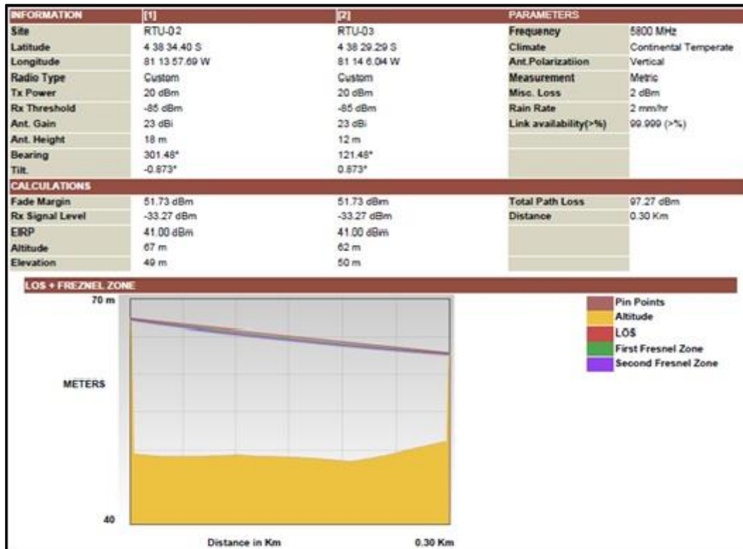
Figura 31. Línea de vista entre las Antenas RTU-02 y RTU-03. Fuente: PTP Link Planner – Shyam.
