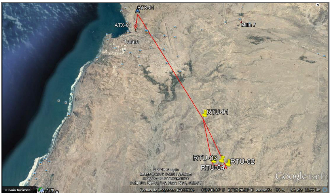
Figura 11. Ubicación de las estaciones remotas, repetidor y control. Fuente: Google Inc.
