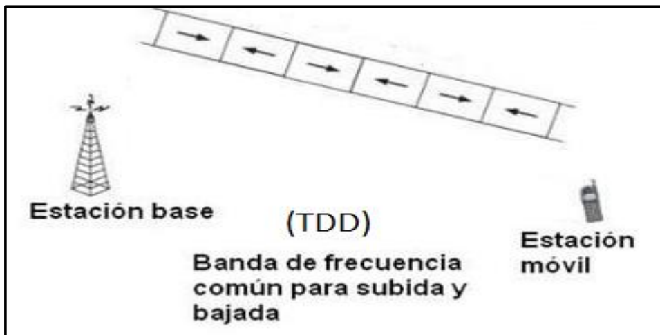
Figura 08. Duplexación por división de tiempo. Fuente: TDD Y FDD por Barriga, R., Guillen, C. y Muruchi, M., 2015.
