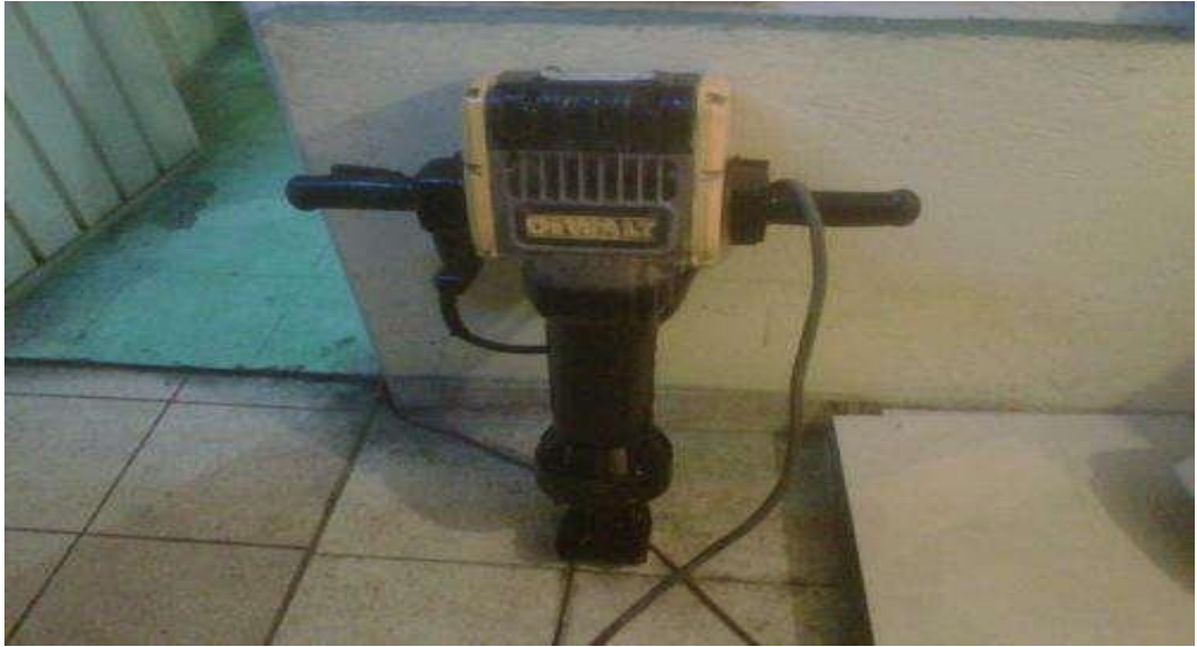
Rotomartillo DeWalt utilizado para la rotura de asfalto y vereda concretada
