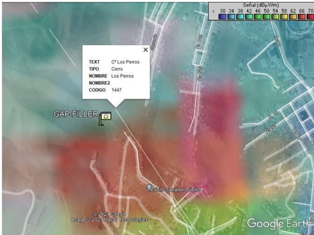
Figura 3.27. Nivel de intensidad de campo en Cerro Los Perros. Fuente: Elaboración propia mediante el programa Google Earth.
