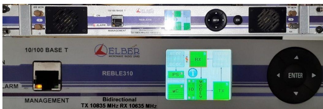
Figura 3.12. Equipo radio enlace microondas Elber Reble310.
