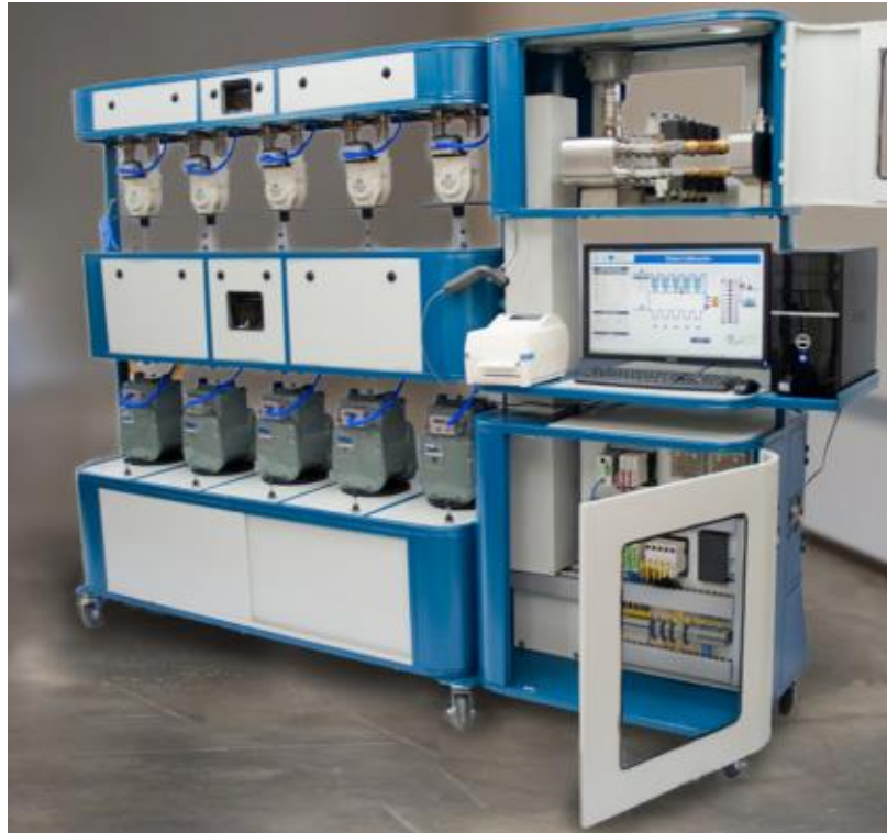
Figura 4. Banco de Toberas automatizados de 5 canales B-Sonic Fuente: German Covelli Solano (2019)
