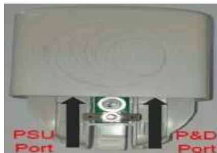
Figura 36 Aterramiento del surge supresor.
