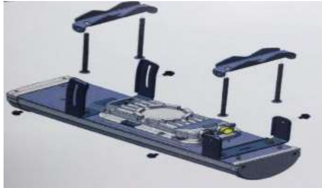
Figura 31 Ensamblaje de las abrazaderas en la antena.
