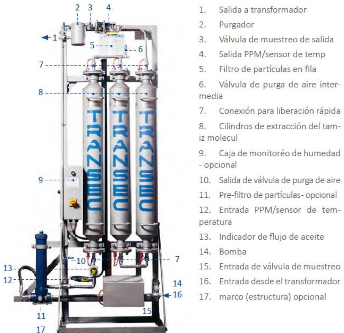
Figura 33: Componentes del equipo TRANSEC CL3.
