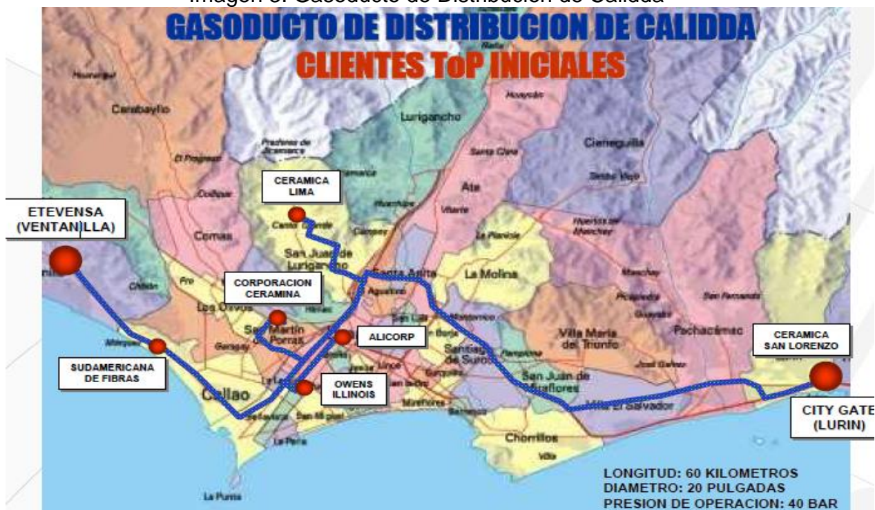
Imagen 3: Gasoducto de Distribución de Calidda
