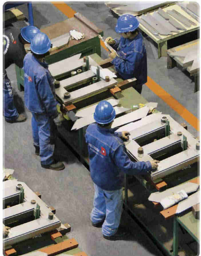
Armado de núcleo apilado
