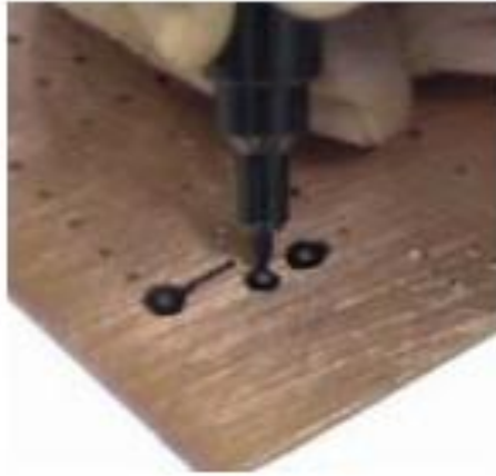
Figura N° 21: Creación de placa PCB por ataque químico
