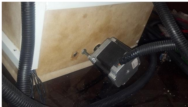
Figura N° 74: Instalación de motor en eje Y
