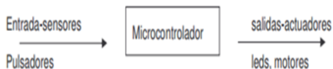
Figura N° 26: Diagrama de funcionamiento de Arduino
