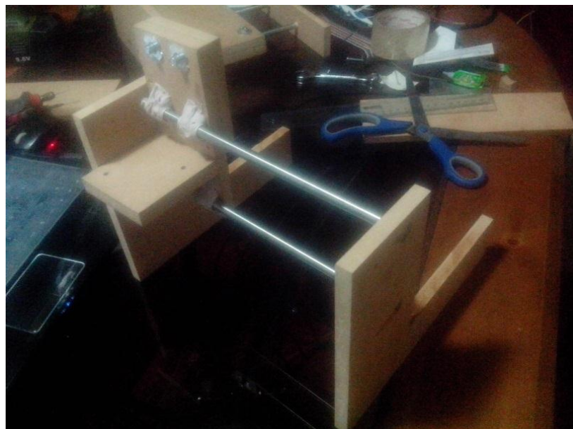
Figura N° 71: Fijación de soporte de fresadora en eje X
