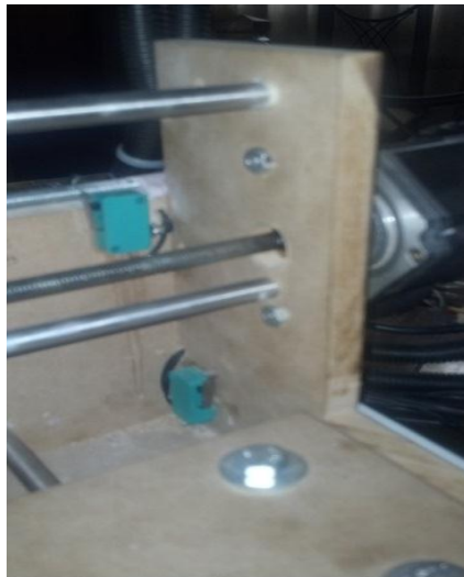
Figura N° 75: Instalación de varilla roscada en eje X
