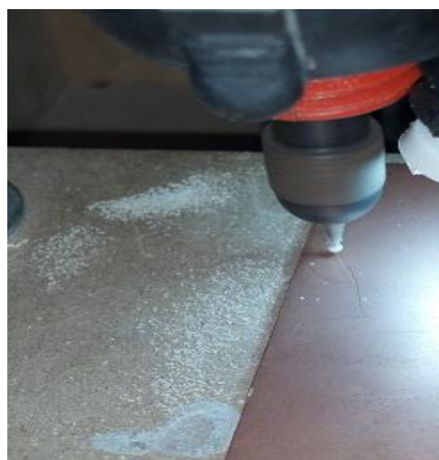
Figura N° 94: Ubicación de herramienta de fresadora en punto de origen
