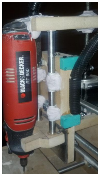
Figura N° 72: Fijación de fresadora y eje Z en soporte
