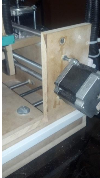
Figura N° 76: Instalación de motor en eje X
