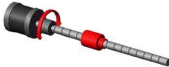
Figura N° 66: Ensamble de motor con varilla roscada
