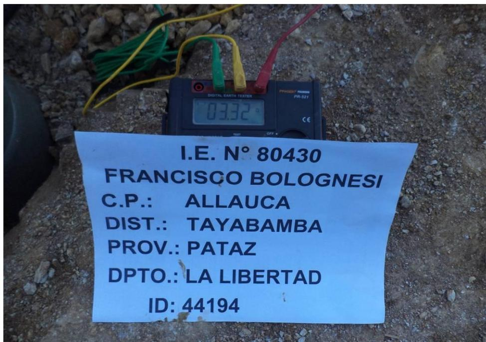
Figura A - Fotografía del Pozo de Tierra de Equipos VSAT (con Lectura de Medida, identificando con nombre de la IE)
