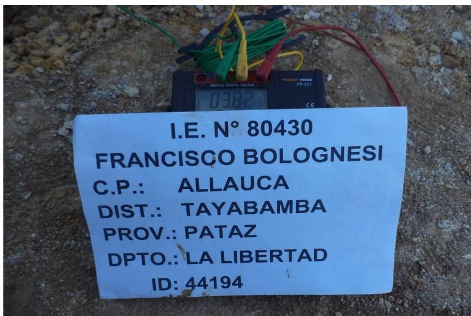
Figura B - Fotografía de Pozo de Tierra del Pararrayos (con Lectura de Medida, identificando con nombre de la IE)
