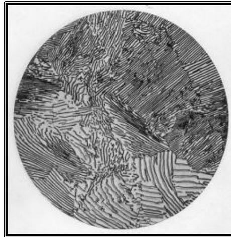
FIGURA N° 05: MICROGRAFÍA A 1000X FE + 0,8% C
