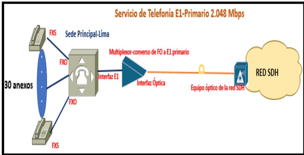
Figura 3.2 Topología del servicio de voz mediante la red SDH.
