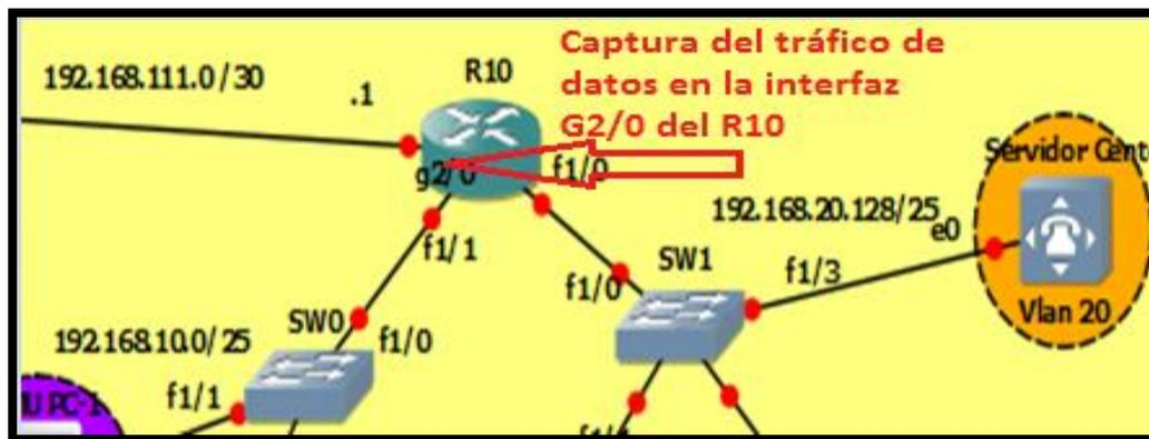
Figura 3.32 Interfaz G2/0 del R10 para la captura de tráfico de voz y datos
