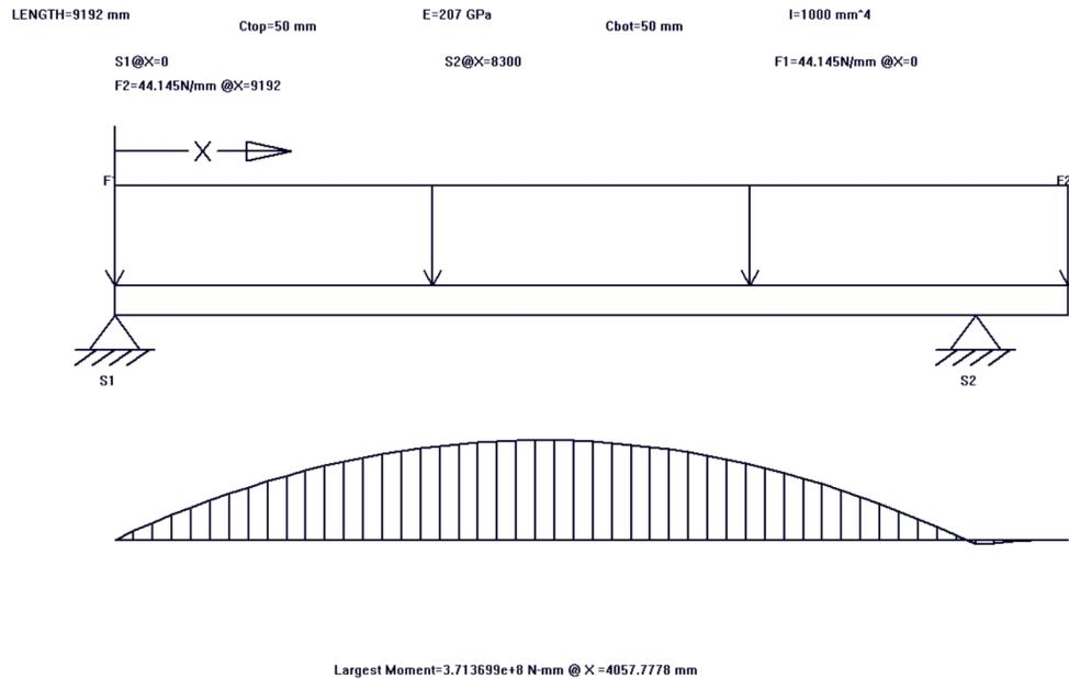
**Figura 7.** Momento flector de la viga.
