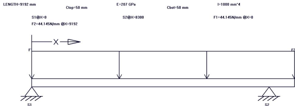
**Figura 6.** Carga sobre la viga.
