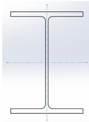
**Figura 3.** Perfil frontal de viga WF.
