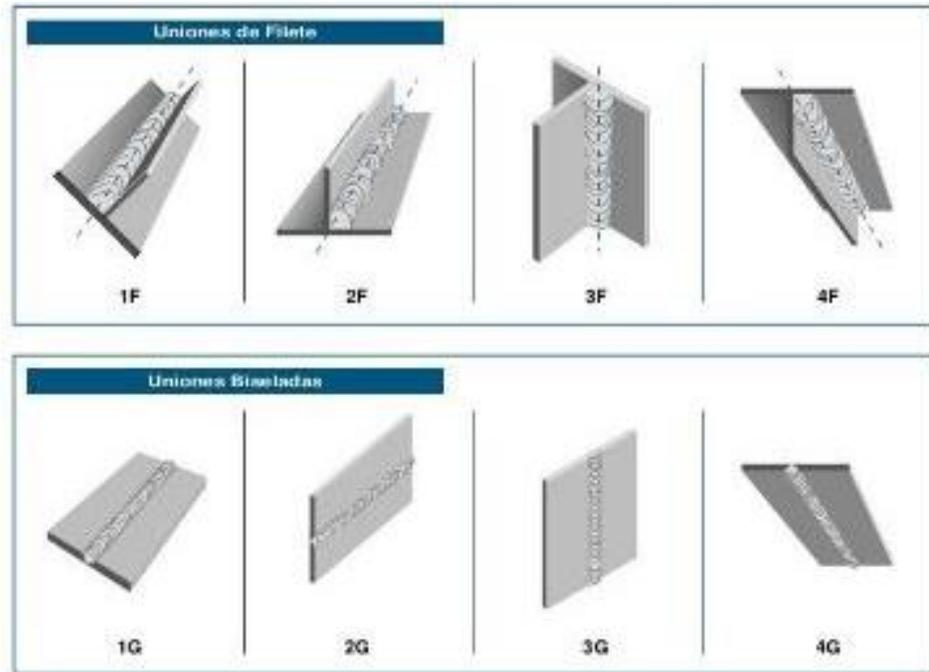
**Figura 4.** Posiciones de soldadura.
