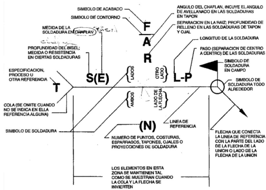
**Figura 5.** Simbología para trabajos de soldadura.
