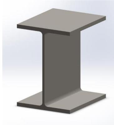
**Figura 2.** Perfil isométrico de viga WF.
