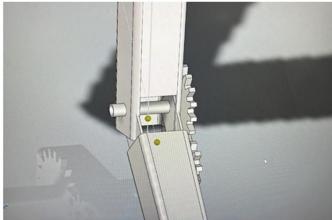
Nota. Como se observa en la figura 13 se muestra el sistema de transmisión de potencia desarrollado a través de engranaje que ejecuta la orientación norte-sur.
