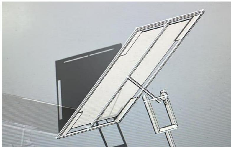
Nota: Modelamiento del seguidor solar de dos ejes en 3D con una vista lateral de la estructura mecánica donde podemos observar las partes mecánicas y el sistema de transmisión de potencia que ejecutará la inclinación Este-Oeste.
