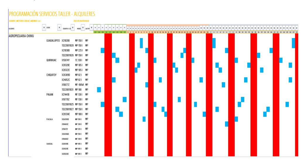
La tabla de control de mantenimiento nos permite verificar la fecha exacta en la que se debe realizar el mantenimiento de un equipo, según el consumo de horas que ha tenido. De esta manera, podemos proyectar el día exacto en el que se debe realizar el mantenimiento.
