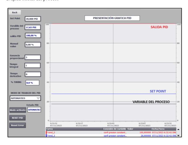
La Figura 84 representa la variable del proceso al alcanzar la presión deseada de 28 PSI a una salida PID 93.25% (55.95 HZ), mostrando un pico de presión en la inicialización de la curva de la variable de proceso.
