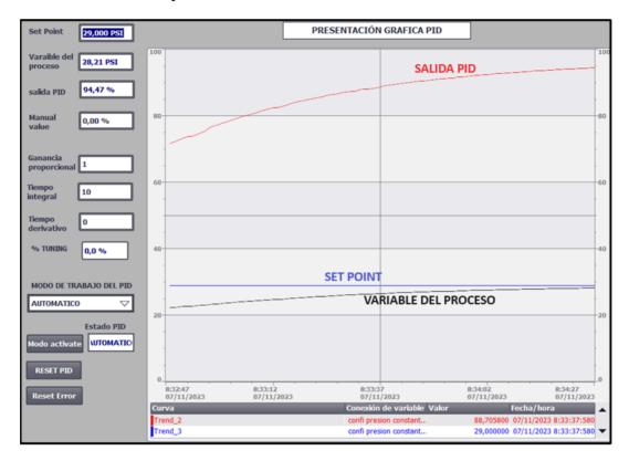
La Figura 88 ilustra cómo la variable real del proceso ha alcanzado su objetivo con una presión de 29.01 PSI, cumpliendo así con la presión deseada de 29 PSI. Se representaron los siguientes parámetros mediante curvas de colores: Tren 1, que corresponde a la variable de proceso 29.01 PSI, se muestra en color negro; Tren 2, que representa la salida PID 97.11% (58.27HZ), se visualiza en color rojo; y Tren 3, que refleja el set point 29 PSI, se representa en color azul.
