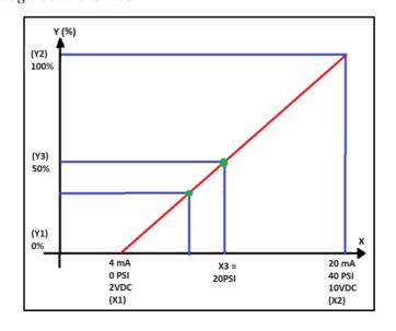
En la figura 65 representa los bloques de escalamiento NORM\_X y SCALE\_X del PLC, ya haber tenido interpretado el escalamiento desde el transmisor de presión, se introduce en valores limites enteros de 5530 (2VDC) y 27648 (10VDC).
