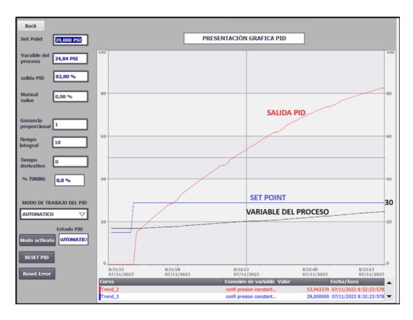
La Figura 87 muestra cómo la variable real del proceso aumenta gradualmente de 28.24 PSI para alcanzar la presión deseada de 29 PSI. En comparación con la Figura 84, que tenía los parámetros de Kp = 3 y Ti = 1 presentaba una respuesta más inmediata en ese contexto. La curva en esta gráfica se desplaza de manera más extensa, indicando un mayor tiempo para llegar al objetivo de presión deseada a una salida PID de 94.47% (56.82 HZ).
