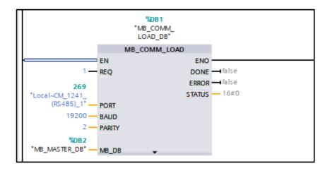
La siguiente figura 56 representa la programación en modo esclavo de los variadores de frecuencia LS y ABB. Definidos por los bloques MB\_MASTER\_DB.
