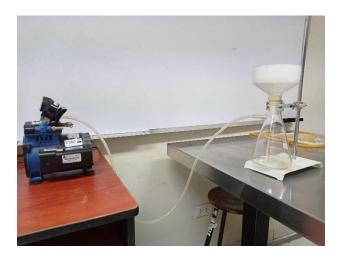
Una vez encendida primero la bomba, con una varilla de vidrio se vaciará el sobrenadante de cada vaso de precipitado en el centro de la superficie disponible del embudo de Buschner, para su filtración.
