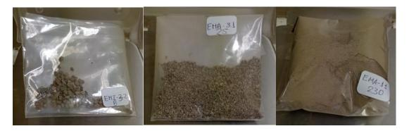
Posteriormente, se somete a un proceso de secado a 70°C por 12 h para determinar el peso de la muestra seca.
