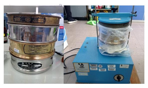
Se pasaron las muestras de sedimentos fluviales por la columna de tamices ajustados a la agitadora por un tiempo de 10 min. cada una.
