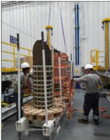
**Foto 13:** Montaje de bobinado AT y BT.
