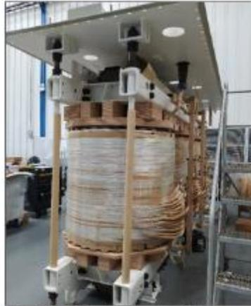
**Foto 15:** Montaje de la tapa del transformador.
