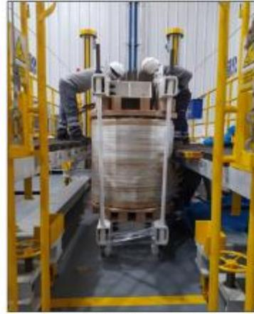
**Foto 14:** Cierre de núcleo y ajuste de sistema de prensado.
