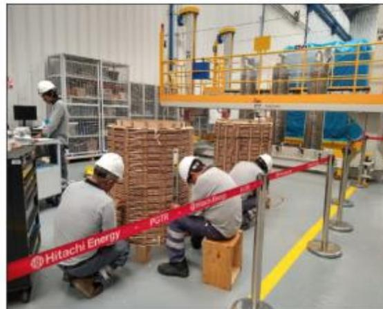
**Foto 11:** Colocación de separadores a las bobinas fabricadas.
