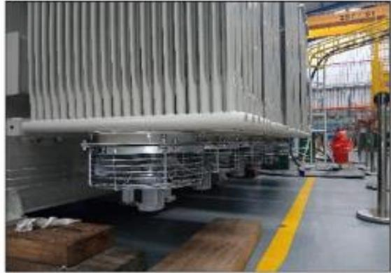
**Foto 26:** Vista de sistema de ventiladores vertical.
