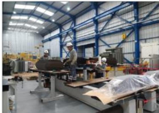
**Foto 06:** Mantenimiento de las láminas del núcleo.
