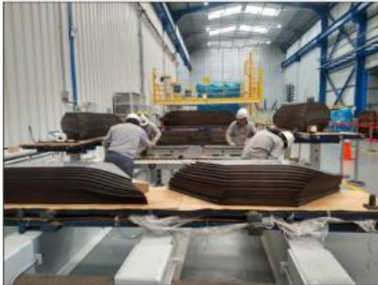
**Foto 07:** Proceso del ensamble del núcleo magnético.
