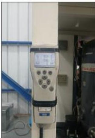
**Foto 35:** Tratamiento de aceite por termovacío y lectura de contenido de agua (< 20 ppm)
