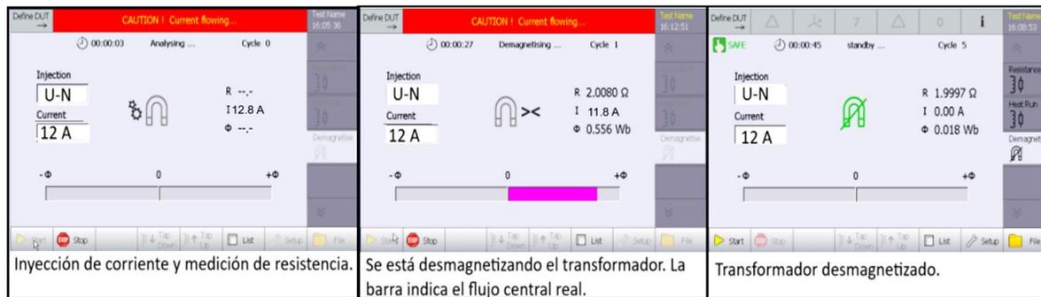
Nota. En la figura se aprecia por paso el funcionamiento del equipo durante la desmagnetización del transformador. Fuente: elaboración propia empleando interfaz del analizador Tettex modelo 2293.
