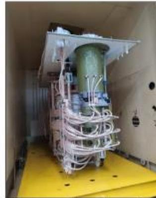
**Foto 21:** Ingreso de parte activa a horno autoclave para proceso de calentamiento, secado y vacío.
