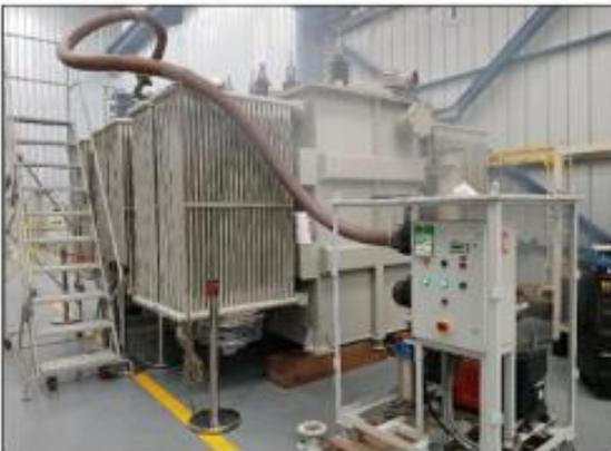
**Foto 30:** Proceso de alto vacío (promedio 1 mbar según procedimiento).
