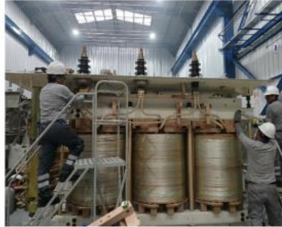
**Foto 20:** Montaje de TC's y bushing de BT.
