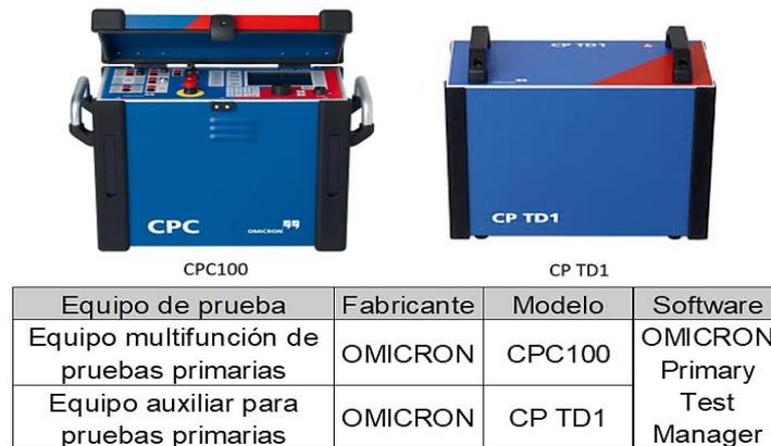
*Nota.* Se aprecia la CPC 100, equipo multifunción que realiza pruebas eléctricas a distintos equipos que presenta una subestación eléctrica. También se aprecia el CP TD1 (fuente de tensión de hasta 10 kV) que es un complemento para ejecutar pruebas de factor de potencia y corriente de excitación. Fuente: elaboración propia.
