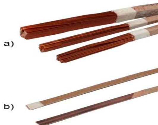
*Nota.* Vista general de la disposición de los alambres rectangulares que conforman el CTC (a) y conductor rectangular aislado con papel crepe (b). Fuente: elaboración propia.
