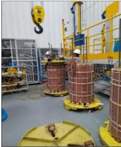
**Foto 12:** Preparación de bobinas para su posterior prensado.
