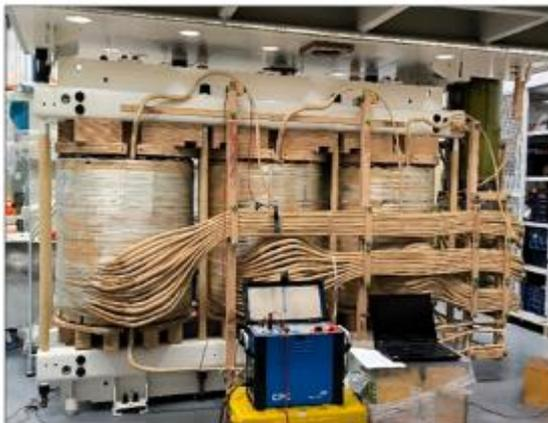
**Foto 19:** Prueba de relación de transformación como control.
