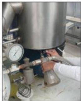
Foto 23: Control del secado de la parte activa mediante el retiro de agua condensada dentro del autoclave.
