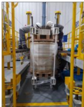
Foto 14: Cierre de núcleo y ajuste de sistema de prensado.
