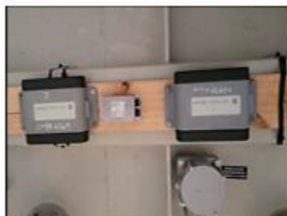
Foto 06: Proceso de retiro de registradores de impacto para su posterior análisis de la data registrada.
