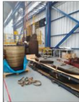
Foto 05: Retiro de las bobinas del núcleo magnético.
