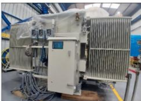
Foto 25: Montaje de radiadores, tablero de OLTC, termómetros de devanados, termómetro de aceite, válvulas de filtrado, válvula de muestreo, toma de muestra de gases, etc.
