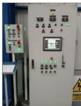
Foto 22: Monitoreo de temperatura y presión de vacío.
