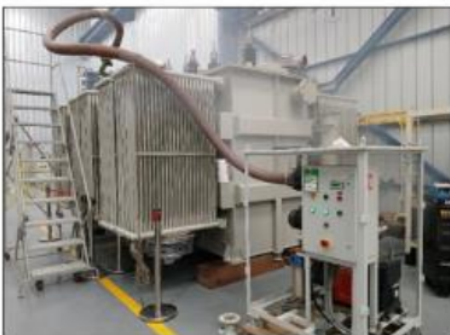
Foto 30: Proceso de alto vacio (promedio 1 mbar según procedimiento).
