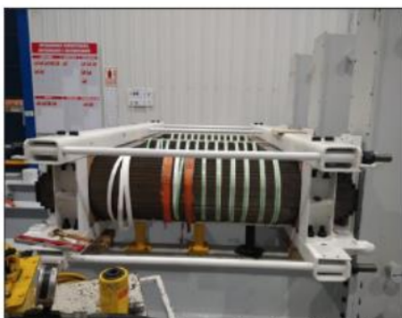
Foto 08: Ensamble terminado del núcleo magnético.
