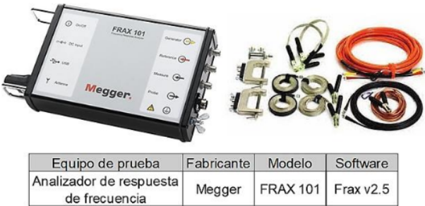
Figura 43 Analizador de respuesta de frecuencia FRAX 101 Megger
