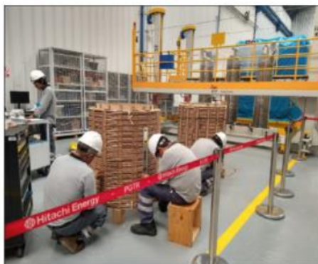
Foto 11: Colocación de separadores a las bobinas fabricadas.
