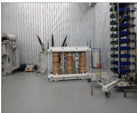
Foto 09: Proceso de magnetización del núcleo.
