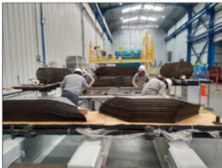
Foto 07: Proceso del ensamble del núcleo magnético.
