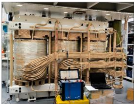
Foto 19: Prueba de relación de transformación como control.
