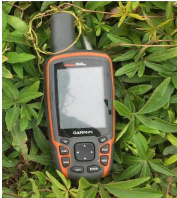
**Figura 8.** Equipo de georeferenciación GPS MAP 64s Garmin
