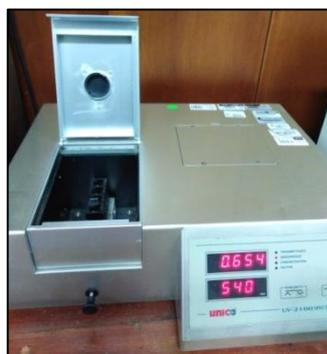
Figura 4. Muestra en espectrofotómetro a una longitud de onda de 540 Nm.
