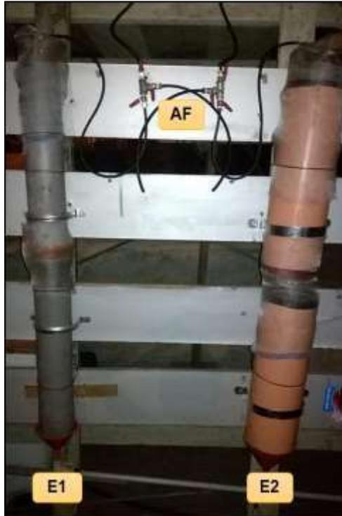
**Figura 22** *Puntos de Monitoreo en el Reactor DHS-G.*
