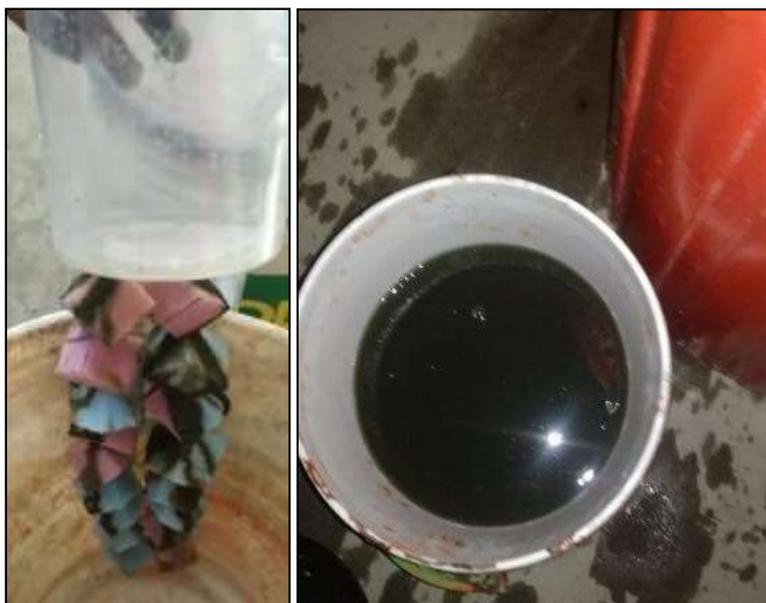
**Figura 48** *Presencia de algas en el tanque regulador de caudal y esponjas de cada módulo de transferencia.*
