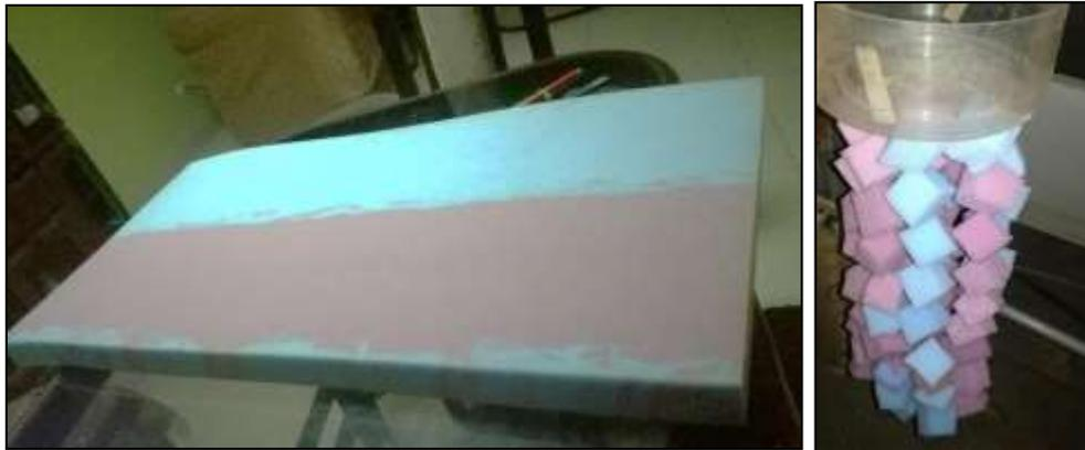
**Figura 17** Esponja tipo V utilizada en el reactor DHS-G1
