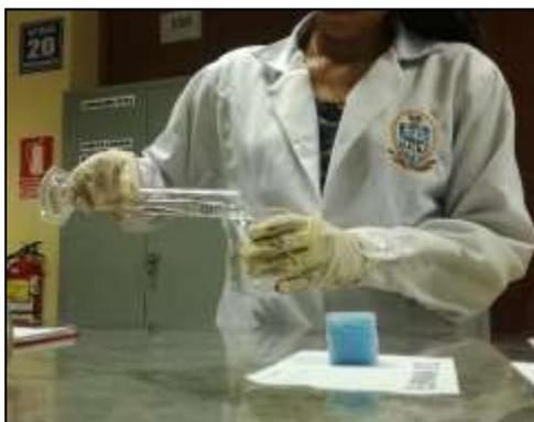
**Figura 19** Medición de 100mL en la probeta para hallar el volumen desplazado
