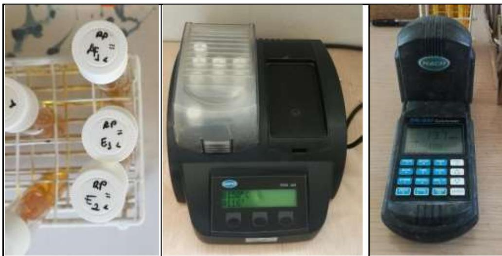
**Figura 27** Viales para DQO, Digestor DBR 200 y colorímetro DR/890.
