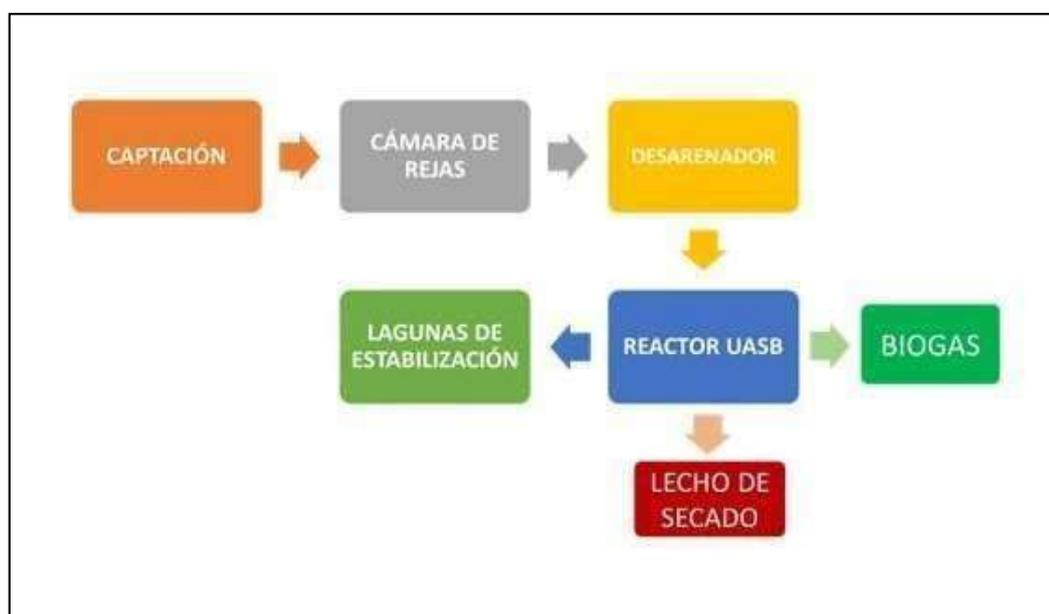
**Figura 8** *Diagrama de flujo del proceso de tratamiento de la Planta de Tratamiento de Agua Residuales de CITRAR de la Universidad Nacional de Ingeniería.*
