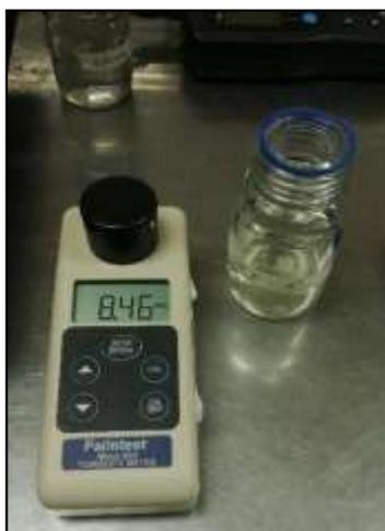
**Figura 25** *Medición de la turbidez del punto E2.*
