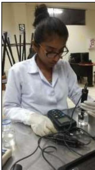
**Figura 24** *Medición de pH del punto E1 con el Multiparámetro portátil HQ40D*
