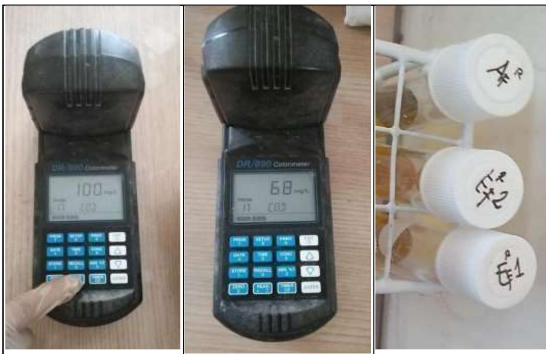
**Figura 47** *Resultados y viales de la medición de Demanda Química de Oxígeno mediante el uso del Colorímetro DR/980 – 1° Período.*
