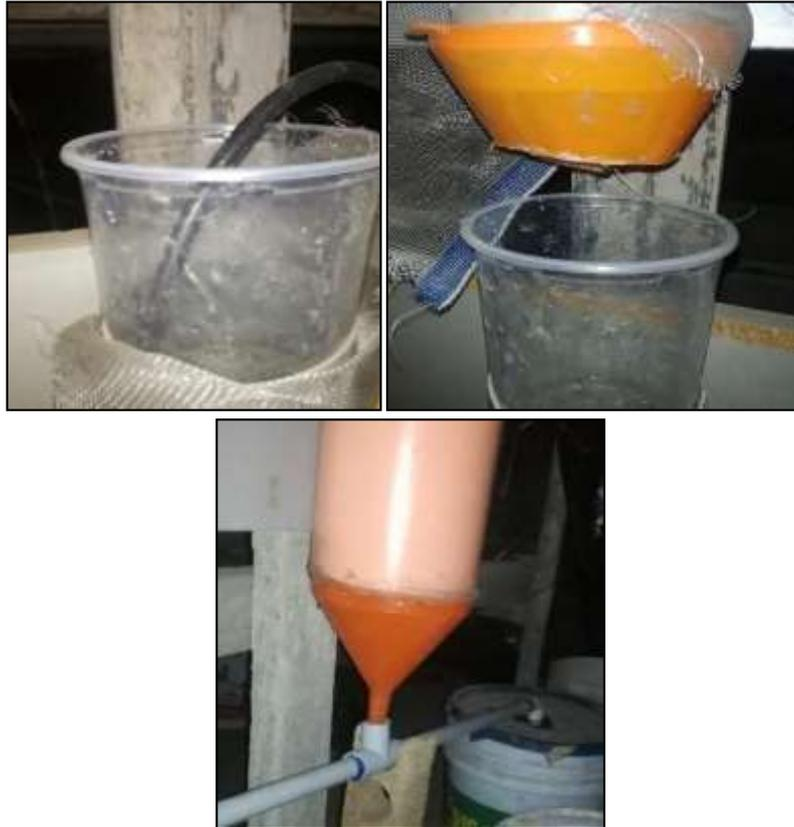
**Figura 16** Vista del sistema de distribución del flujo de ingreso y salida del reactor DHS en ambos Sistemas 1 y 2.
