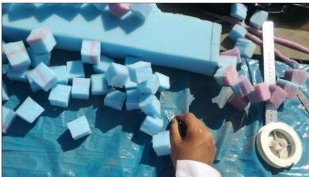
**Figura 49** *Corte y cambio de esponjas por la contaminación de algas en el Reactor DHS de primera generación.*
