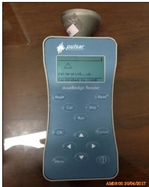
**Figura 5: Calibración del monitor personal de ruido**
