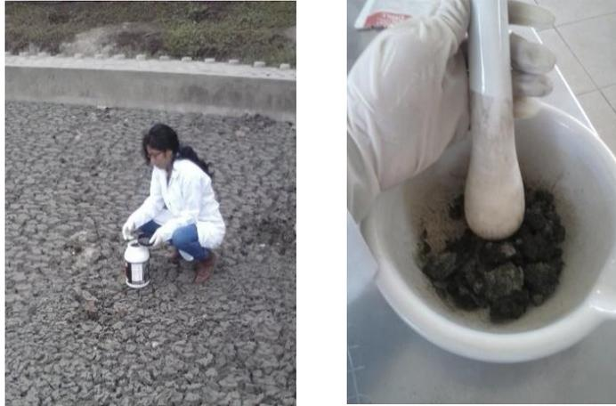
*Figura 10. a. Recolección del lodo residual. b. Molienda del lodo residual.*
