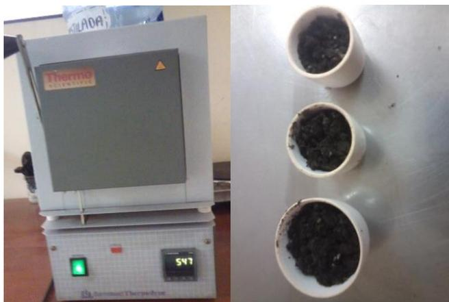
*Figura 13. a. Pirólisis del carbon activado. b. Carbón pirolisado.*
