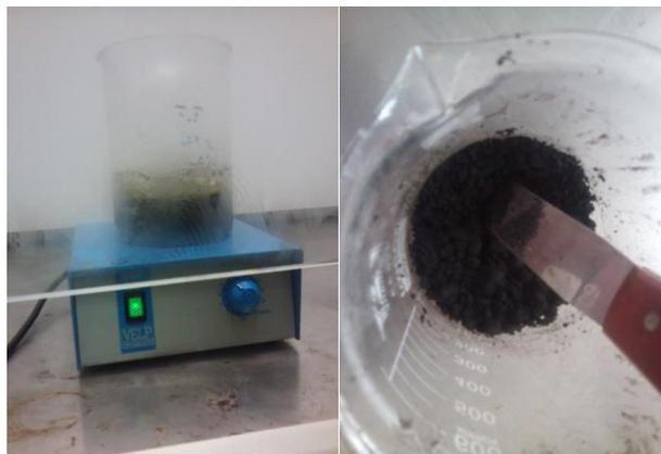
*Figura 14. a. Lavado con HCl. b. Carbón Activado obtenido.*
