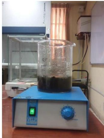
*Figura 11. Impregnación del lodo con  $ZnCl_2$*
