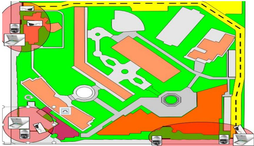
Figura 65. Plano de distribución de RouterBoard de la Universidad Nacional Tecnológica de Lima Sur – UNTELS.
