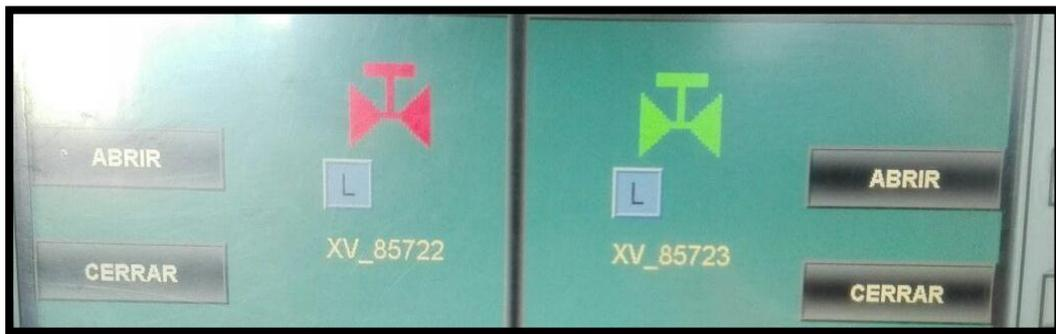
**Figura 93:** Válvulas Neumáticas en funcionamiento
