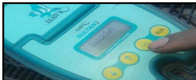
**Figura 73:** Menú de configuración rápida
