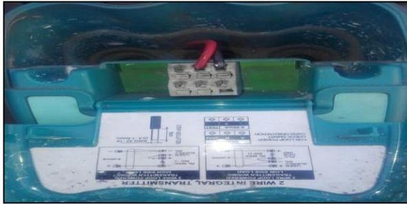
**Figura 67:** Conexión del sensor de nivel Sultan
