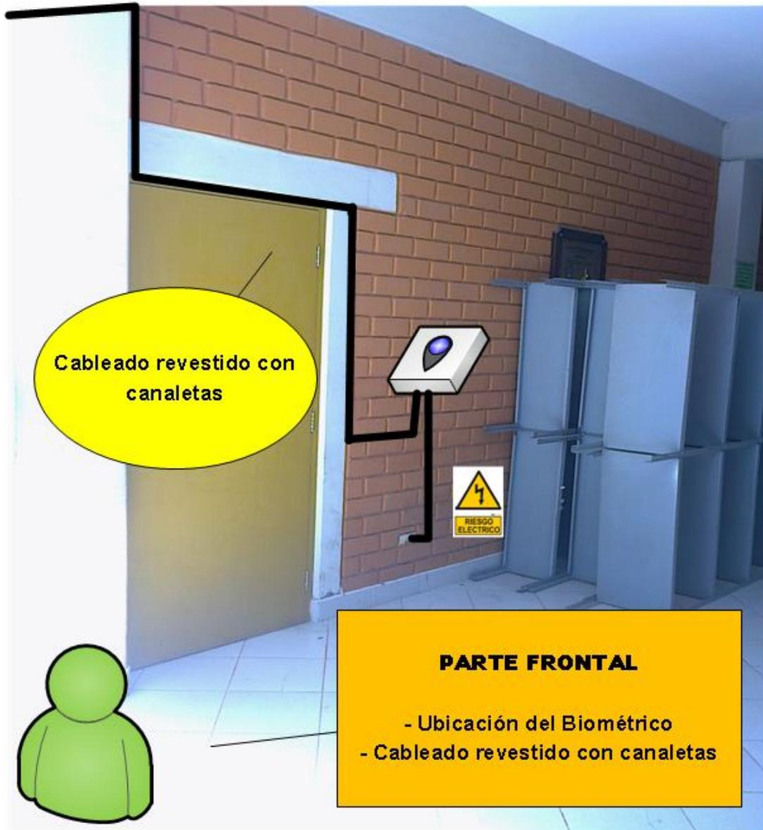
**Ilustración 29:** Ubicación del Biométrico en el edificio Alimentarias
