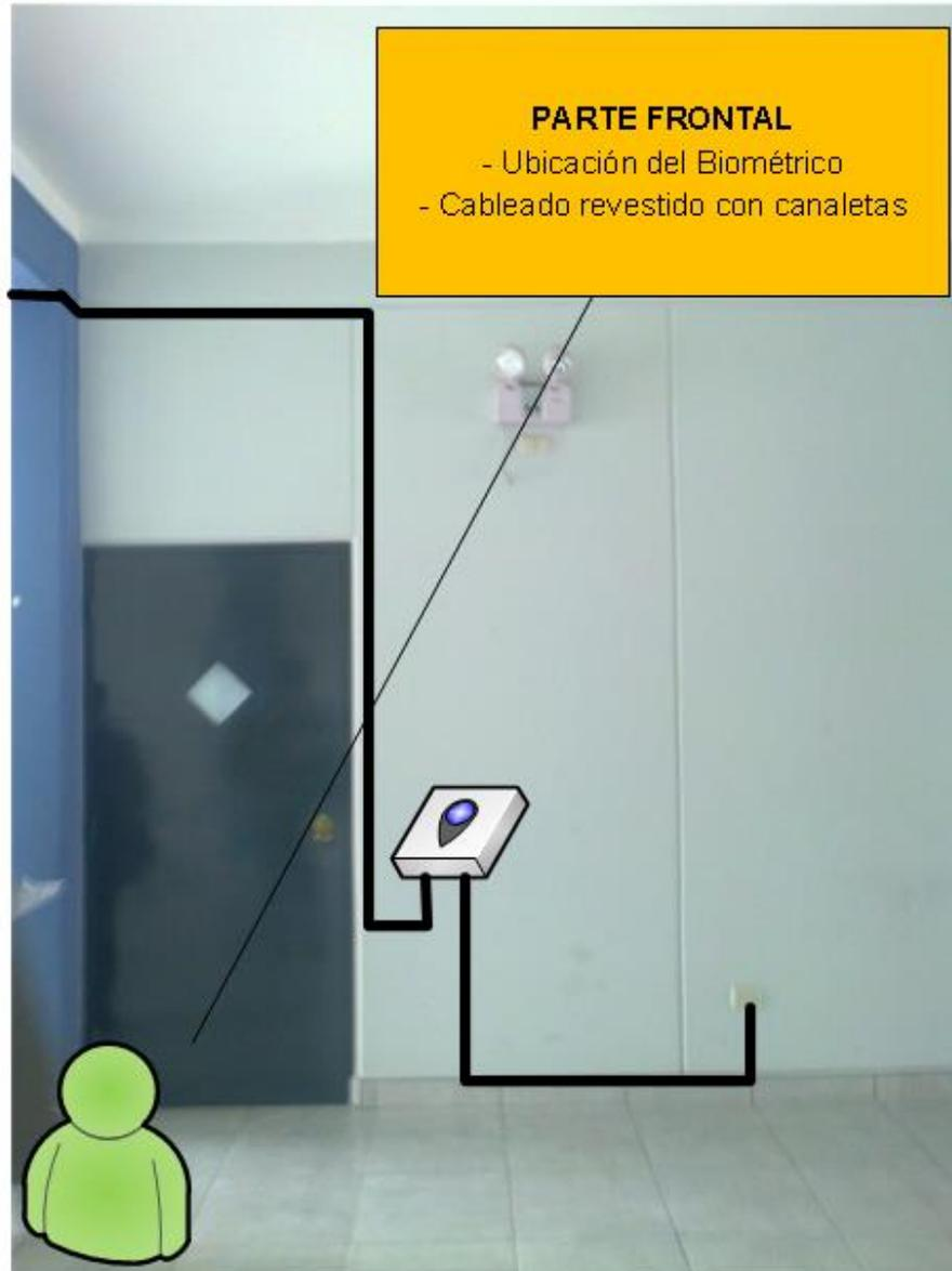
**Ilustración 23:** Ubicación del Biométrico en el edificio Jurídico
