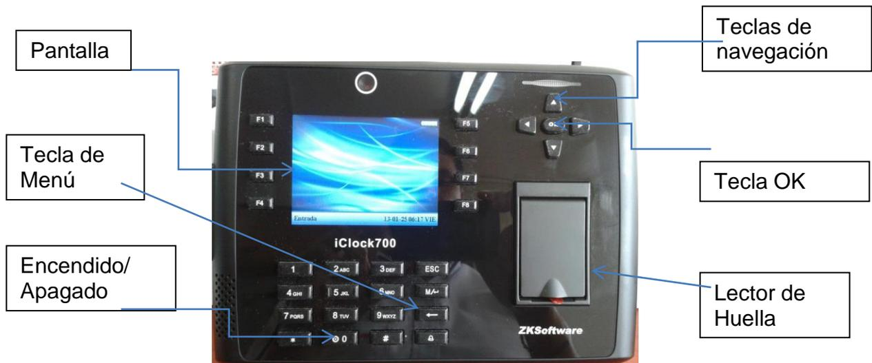
**Ilustración 18:** Partes del biométrico ICLOCK700
