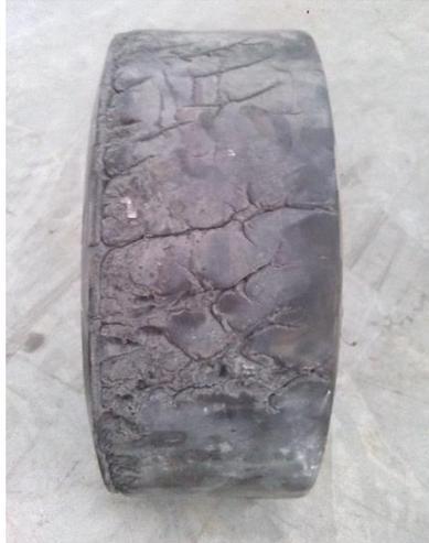
Fig. 1. Estado actual de rueda motriz de apilador eléctrico
