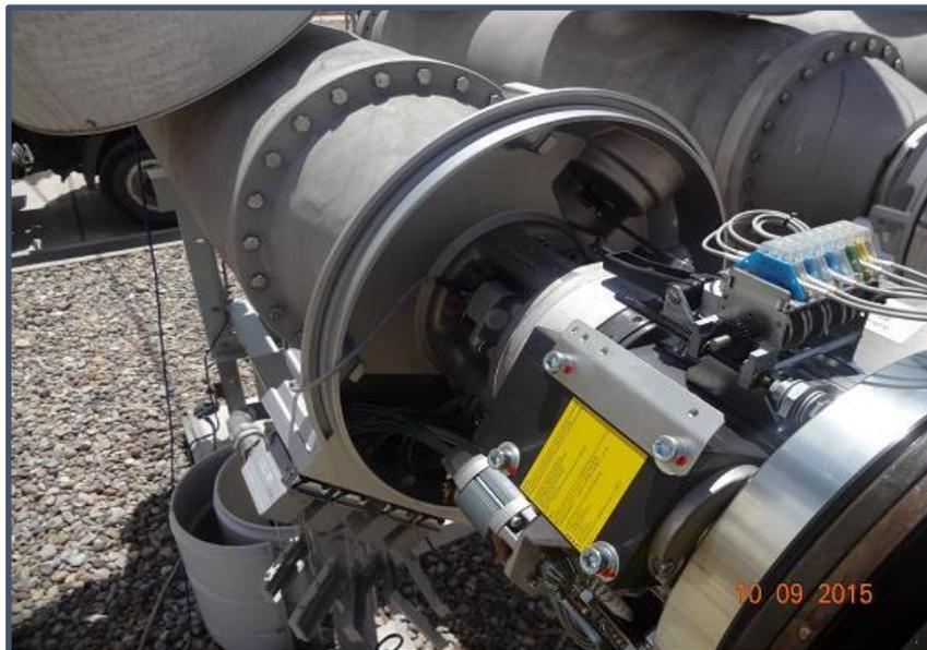
**Imagen 02.** Inspección del mecanismo HMB 8.1, instalación de transductor para realizar las pruebas
