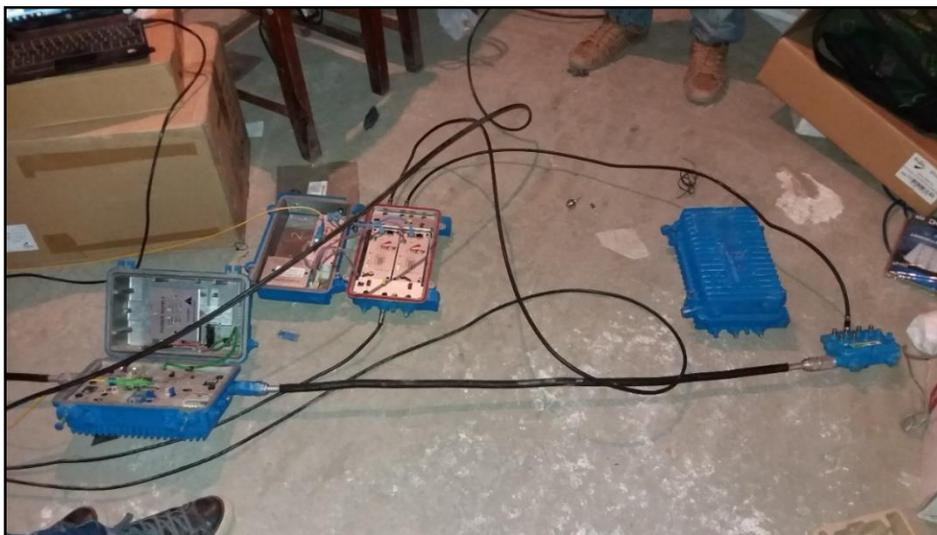
*Figura 27. Acondicionamiento de Master MIZU al nodo óptico de CATV*
