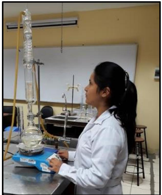
**Registro Fotográfico 6.**Extracción del aceite con equipo Soxhlet
