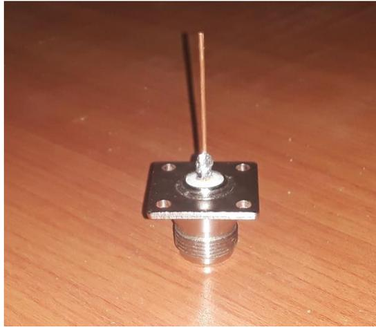
**Figura 40. Sonda coaxial conecta al conector SMA Hembra. Fuente: Elaboración propia**
