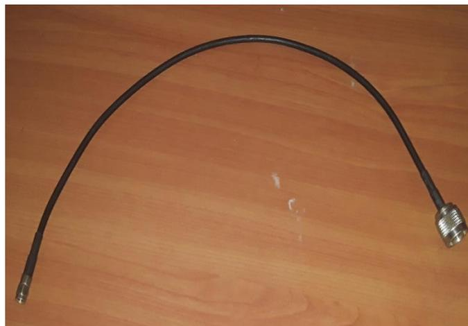
Figura 38. Cable Coaxial RP-SMA. Fuente: Elaboración propia
