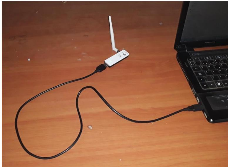
Figura 52. USB WIFI conectado a PC. Fuente: Elaboración propia
