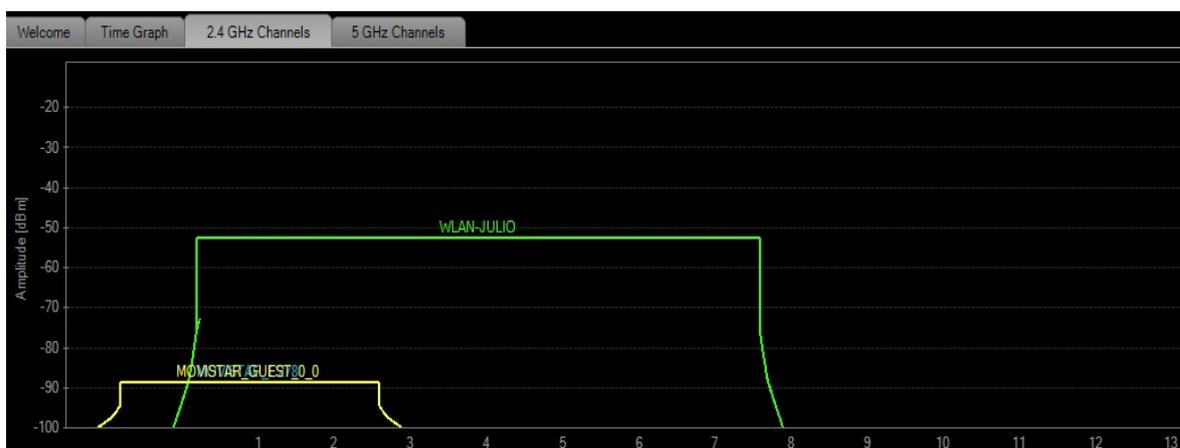
**Figura 61. Gráfica del canal o canales de operación de la antena guía de onda en la red WLAN-JULIO. Fuente: Elaboración propia.**
