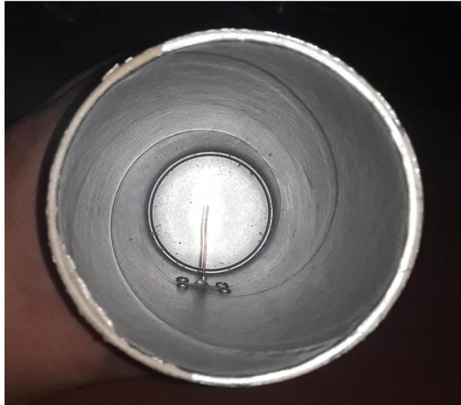
**Figura 42. Forma del ensamblado SMA Hembra en la Guía de Onda. Fuente: Elaboración propia**
