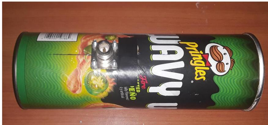
**Figura 41. Sonda Coaxial atornillada con el conector SMA Hembra. Fuente: Elaboración propia**
