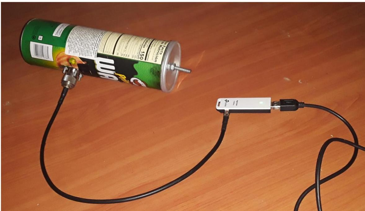
**Figura 44. Antena Guía de Onda Circular con Estructura Helicoidal. Fuente: Elaboración propia**
