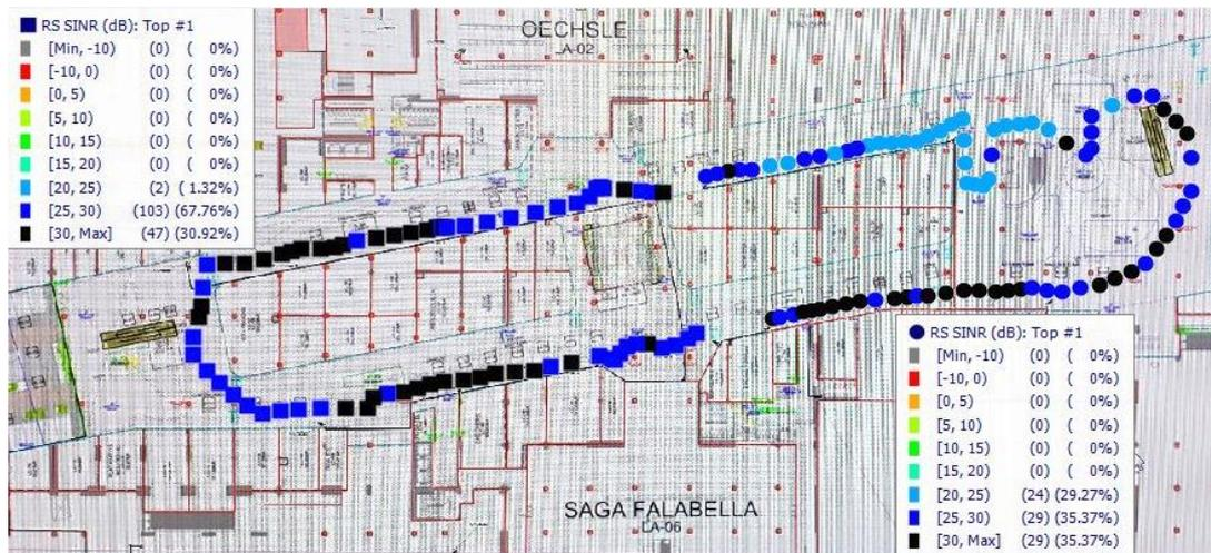
Figura 28 : Medición SNR LTE piso 1
