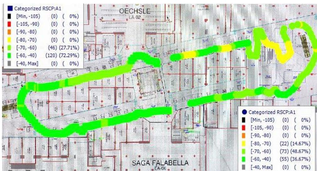
Figura 24 : Medición RCSP Piso 1
