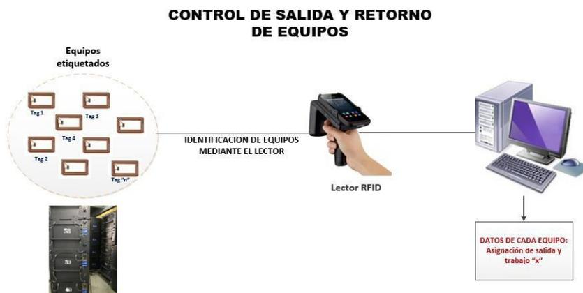
Figura N° 33: Esquema de la salida y entrada de equipos.
