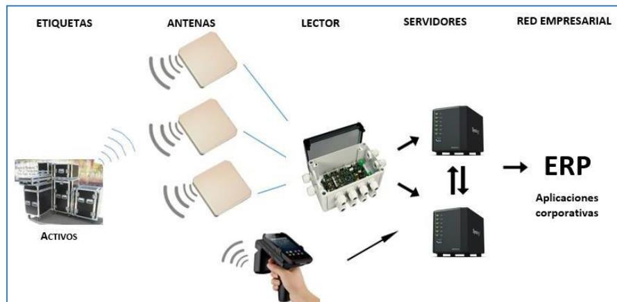
Figura N° 16: Arquitectura de la red RFID para el sistema de ubicación y control de activos
