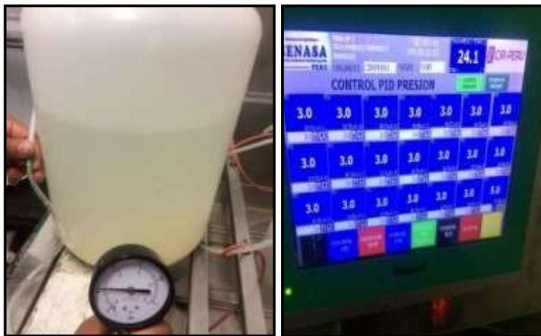
**Figura 21:** Regulación de presión de las botellas
