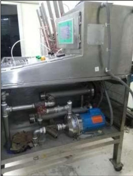
Tina de incubación de larvas, se puede apreciar la bomba que administra el agua y las resistencias que calientan el agua hasta los 35°C.
