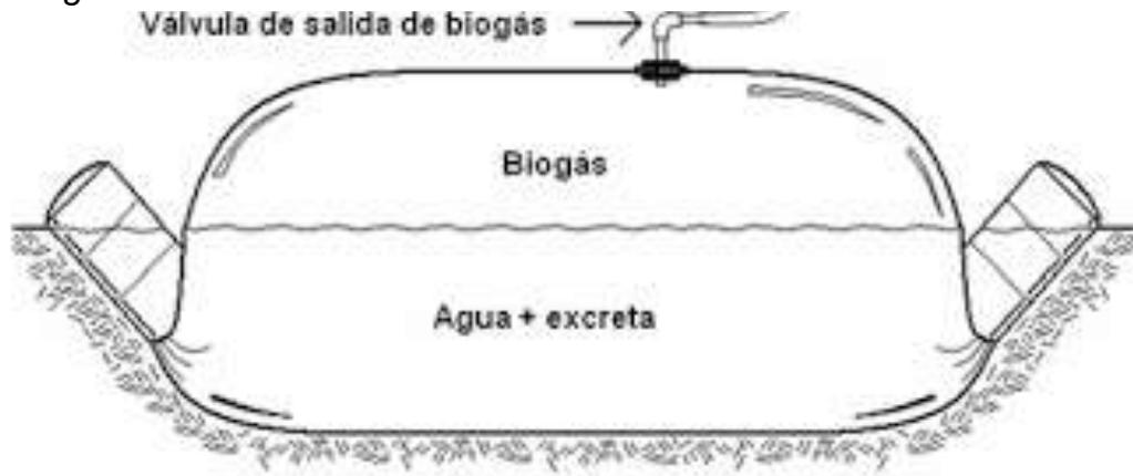
Según Toala (2013) menciona los principales componentes del biodigestor modelo tubular:
