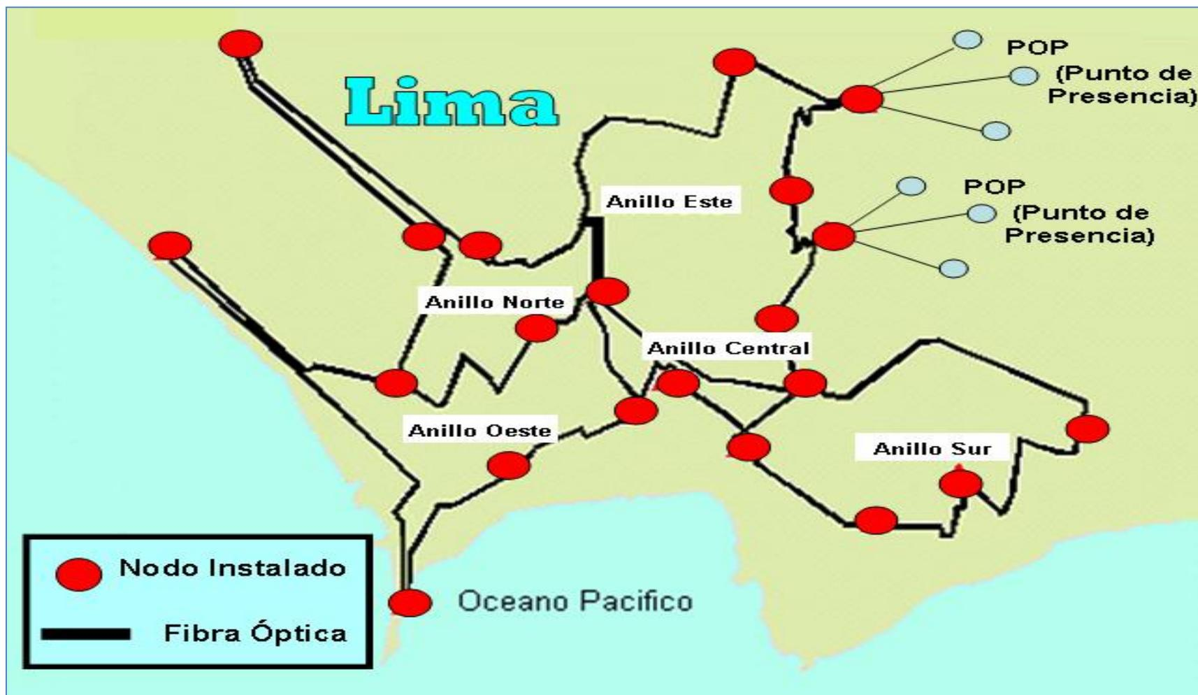
Figura 3.1: Topología de núcleo redundante – fuente: Claro Perú
