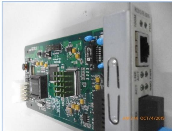
**Figura 3.8: Tarjeta para media converter**
