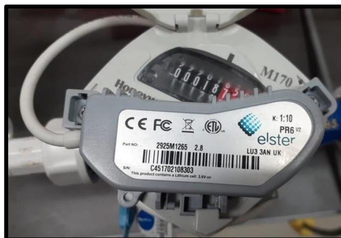
**Figura 23** Adaptador de salida de pulsos modelo PR6 de Elster.
