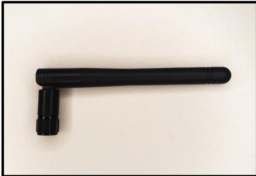
**Figura 27** Antena monopolo Wodf-920.
