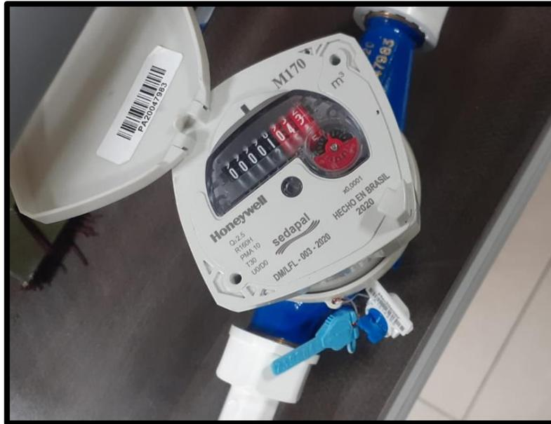
**Figura 22** Medidor de agua Elster M170.
