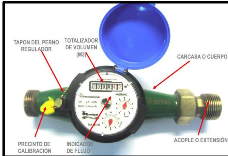
**Figura 7** Partes del Medidor. Vista externa.
