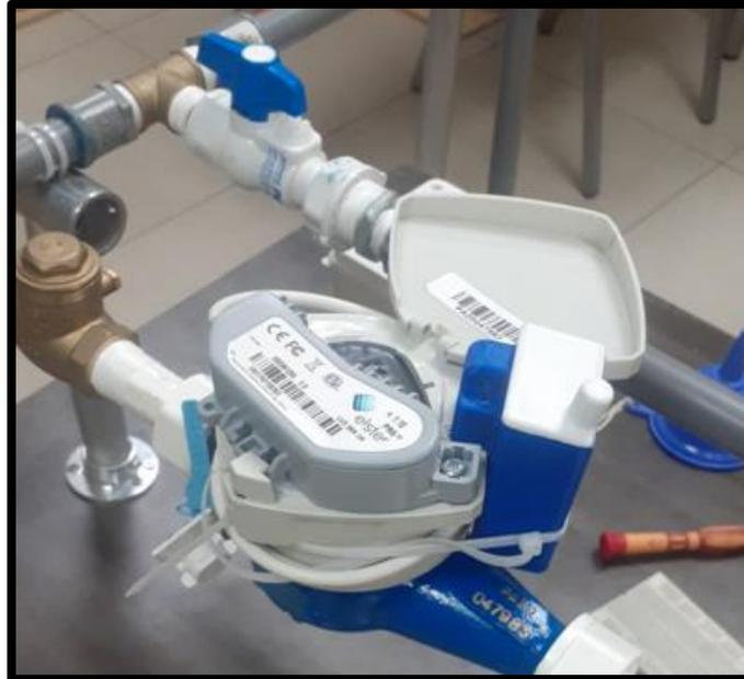
**Figura 55** Circuito de baja potencia instalado en el medidor de agua Elster.
