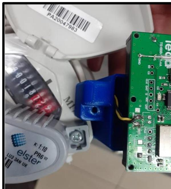
**Figura 54** Conexión de cable de salida de pulsos con tarjeta electrónica
