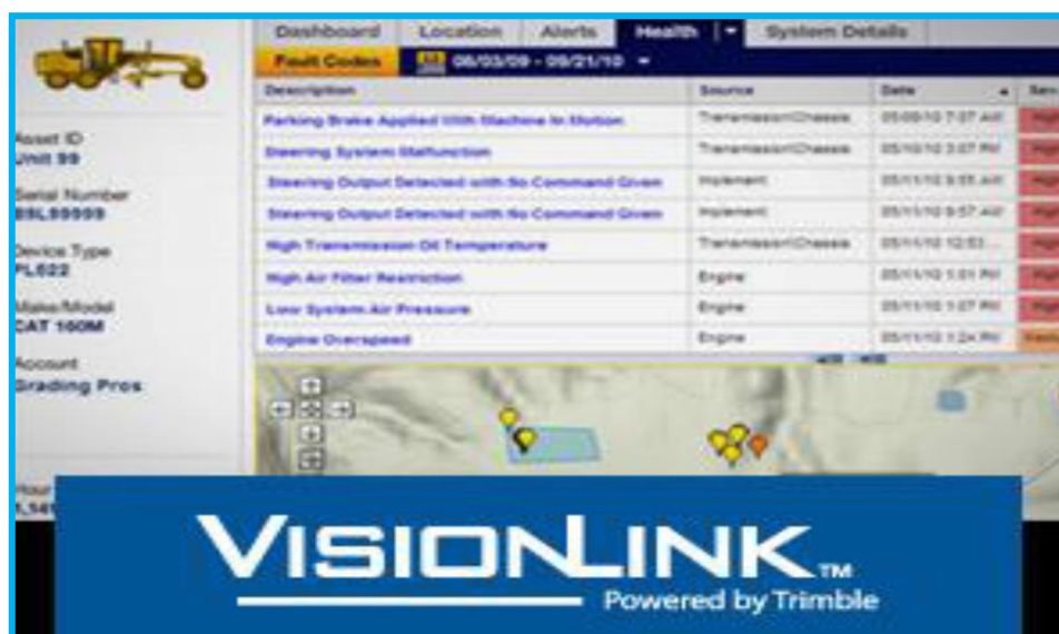
FIGURA N°13: PLATAFORMA VISION LINK – GPS A UN EQUIPO CATERPILLAR
