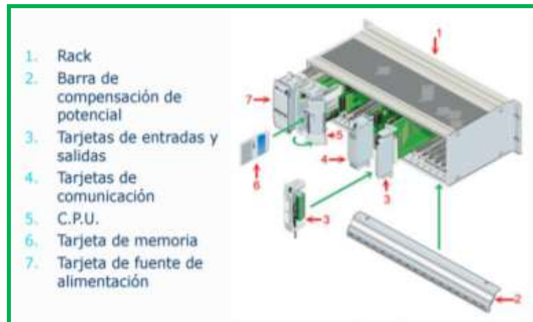
FIGURA Nº 10: ESTRUCTURA DEL PLC MODULAR
