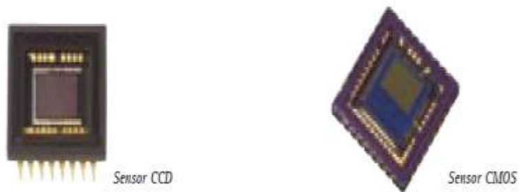
Figura 7. Tipos de sensores CCD y CMOS
