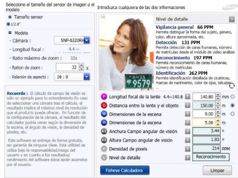
Figura 32. Simulación del lente de la cámara SNP-6320RH
