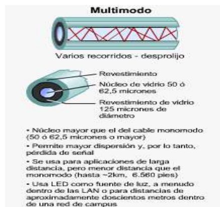
Figura 25. Fibra Óptica multimodo por dentro.
