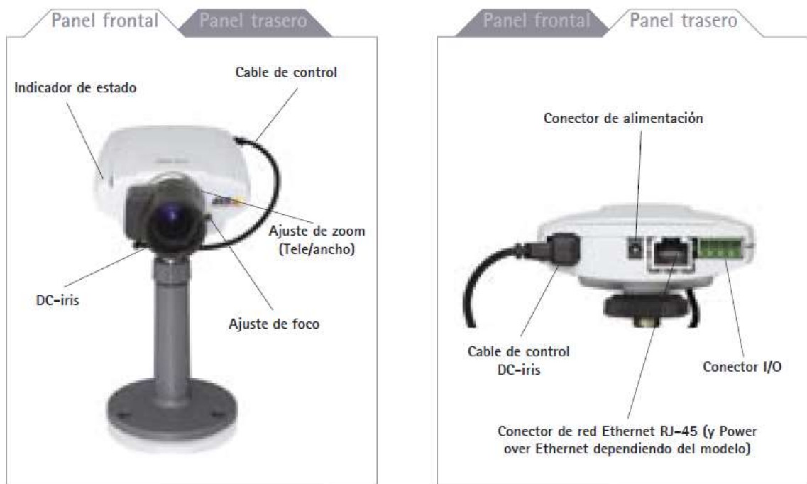
Figura 4. Componentes externos de una cámara
