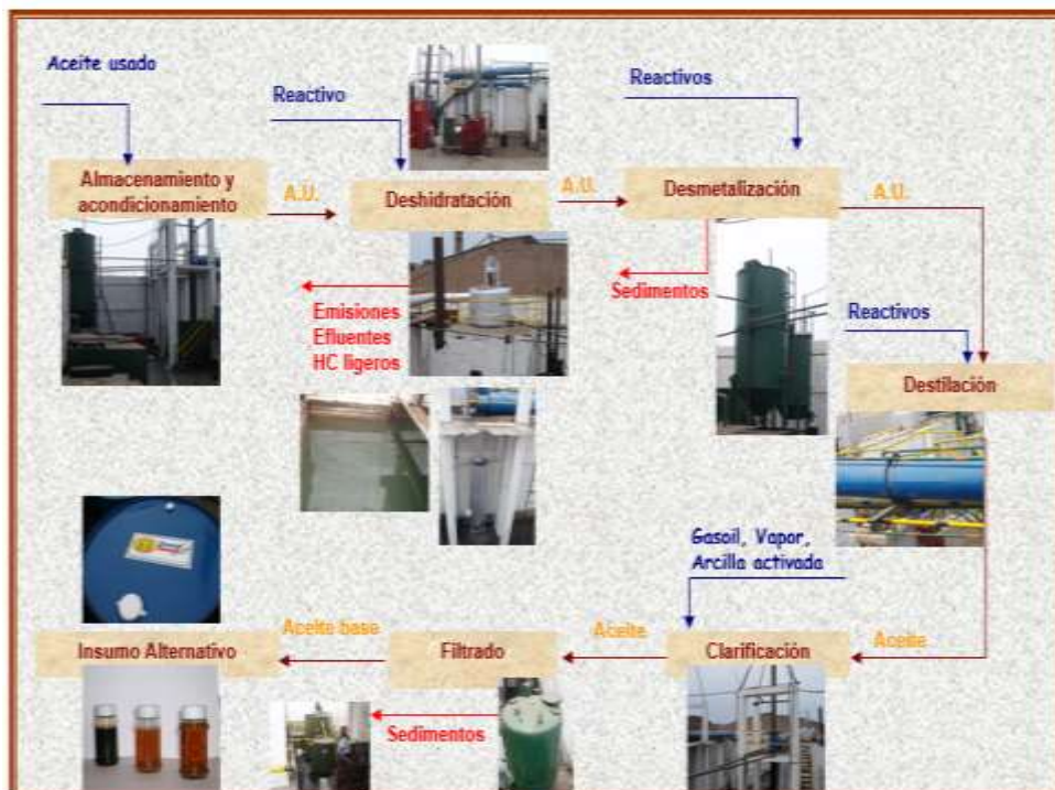
Figura 7. Tratamiento Físicoquímico Planta Refinación Aceite Usado
