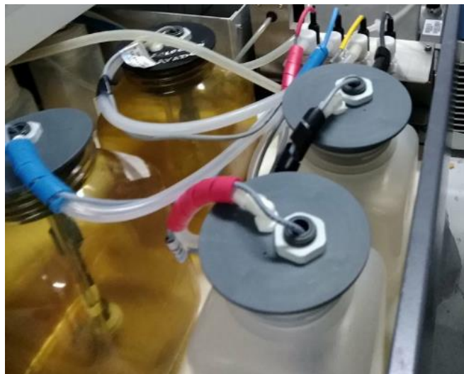
Figura 51. Reservorios para el lavado de placa Fuente: Elaboración propia
