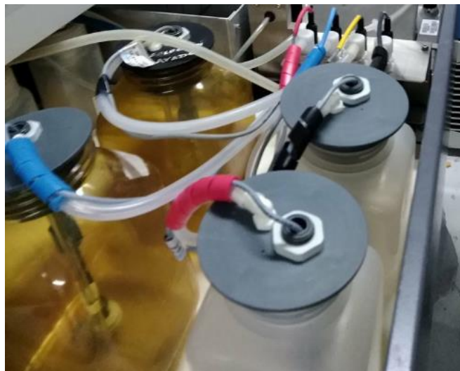
Figura 49. Reservorios para el lavado de placa Fuente: Elaboración propia
