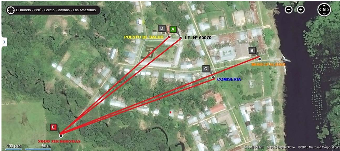
FIGURA 3.6 Enlaces desde el nodo microondas hacia las instituciones públicas. Fuente: Propia
