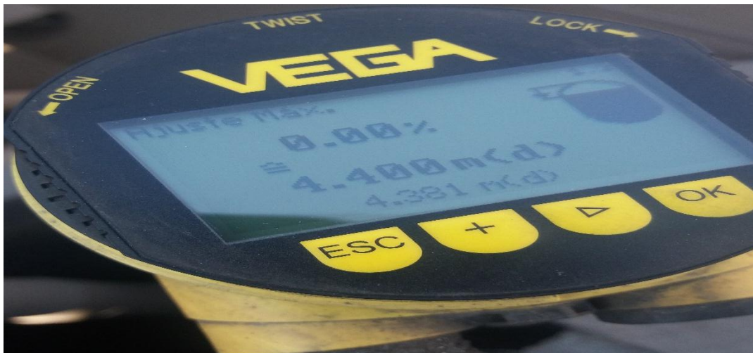
Figura 3.32. Nivel mínimo del tanque Fuente: elaboración propia
